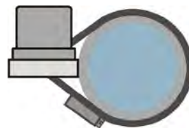
Vista superior del sensor instalado en el tubo
