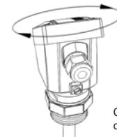
Caja de conexiones orientable
