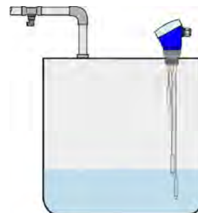
Detecció de nivell màxim i mínim
