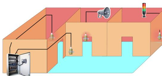
Puede activar directamente elementos de señalización y de alarma o bien que envíe la señal a centros de control.
