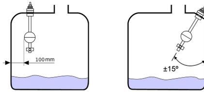
Si le réservoir a des parois métalliques, le capteur doit être séparé de celles-ci d'au moins 100 m.
