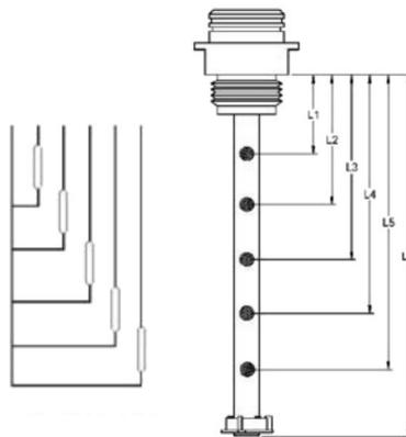
Pour définir le type de contact (NO, NC, NANC) il faut l'entendre sans la présence du flotteur. Par exemple, si vous souhaitez qu'un contact s'ouvre à l'extrémité inférieure du capteur lorsque le réservoir est à court de liquide, vous devez commander un contact NC pour ce poste.
