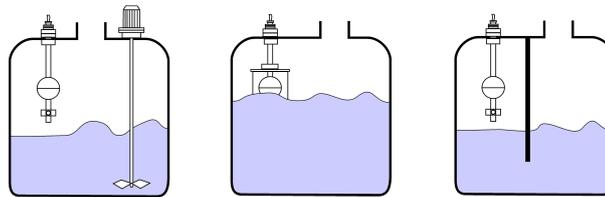
Placez le capteur aussi loin que possible des zones de turbulence.
