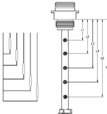
**Contactos** Para definir el tipo de contacto (NA, NC, NANC) debe entenderse sin la presencia del flotador. Por ejemplo, si se desea que en el extremo inferior del sensor se abra un contacto cuando el depósito se quede sin líquido, deberá pedir un contacto NC para dicha posición.
