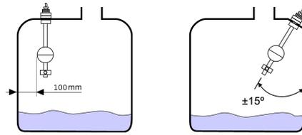
Si el depósito es de paredes metálicas, el sensor deberá separarse de estas al menos 100m.
